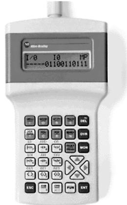
Gambar 3.14 *Hand held programmer* dari PLC Allen Bradley
